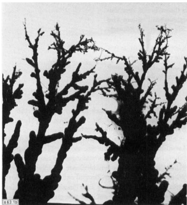
Abb. 1. a) Rasterelektronenmikroskopische Aufnahme eines Wolframdrahtes von 10 \mu\text{m} Durchmesser, der mit Benzonitrildampf bei 1200 °C aktiviert wurde. Die Mikronadeln sind etwa 20 \mu\text{m} lang; b) Aufnahme von Mikronadeln mit einem Transmissionselektronenmikroskop. Auf und zwischen den Mikronadeln befindet sich ein dünner Niederschlag (geringere Schwärzung) von D-Glucose, die aus 0,01 M wäßriger Lösung abgeschieden wurde. Durch einige Glucosefäden (nach Verdunstung des Wassers entstanden) werden die Enden der feinen Nadeln einander genähert und dabei etwas durchgebogen.
